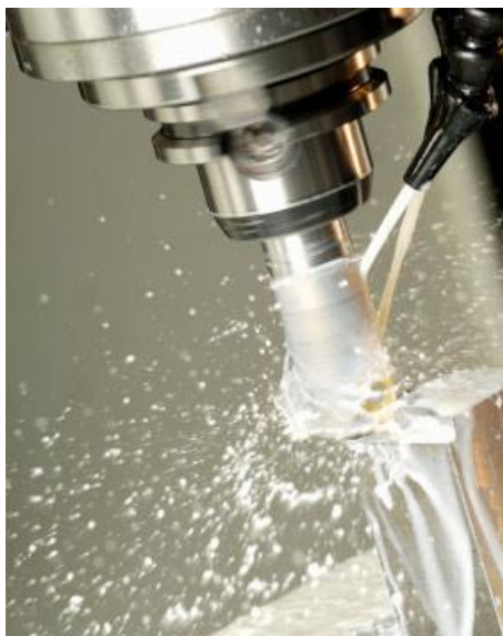
Figura 3: Exemplo de aplicação da lubrificação abundante na maquinagem.
