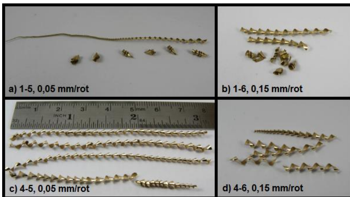
Figura 62: Aparas geradas na furação a Seco dos latões 1 (CuZn39Pb3) e 4 (ECOASB20-Z2.1), para a velocidade de corte de 50 m/min em função dos avanços: a=0,05 mm/rot, b=0,15 mm/rot, c=0,05 mm/rot e d =0,15 mm/rot.
