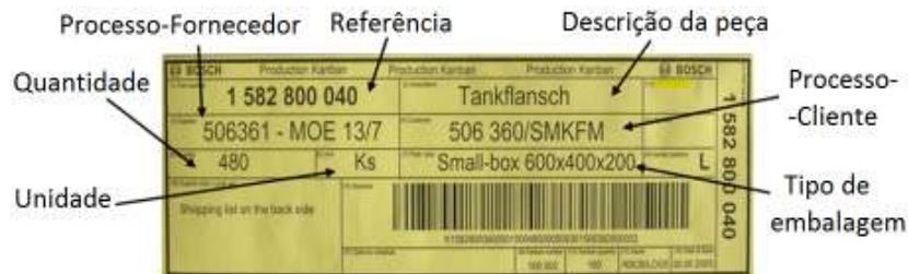
Figura 2 – Exemplo de um *Kanban* de Produção Bosch (Fonte: Bosch, 2011)
