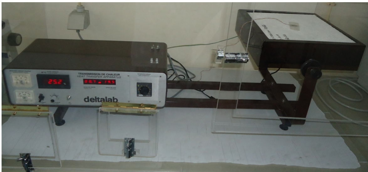
Figura 20: Aparelho utilizado para a medição da condutividade térmica das placas.
