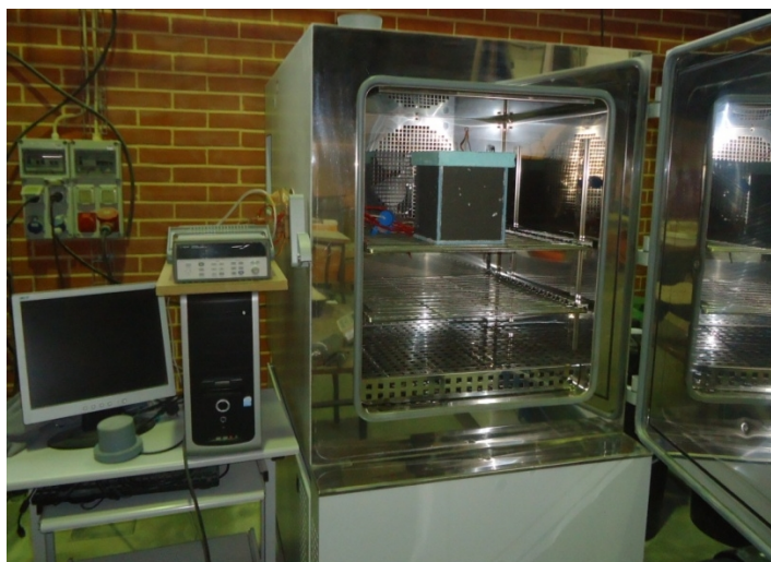
Figura 26: Câmara climática equipada com Datalog para o registo da temperatura ao longo do ensaio.
