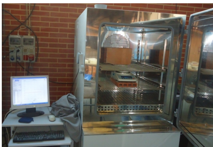
Figura 23: Câmara climática usada para medir o MBV prático .
