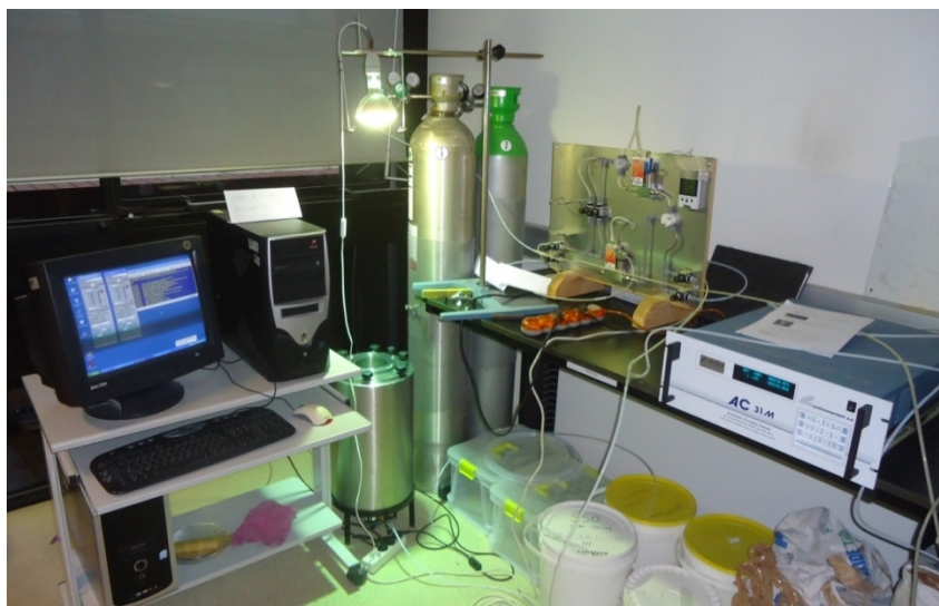
Figura 29: Reator fotocatalítico utilizado nos ensaios de descontaminação gasosa instalado no departamento de Engenharia Civil.
