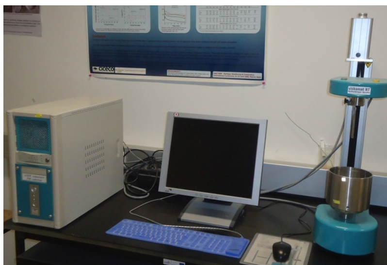
Figura 16: Reómetro utilizado no ensaio de reologia das argamassas.
