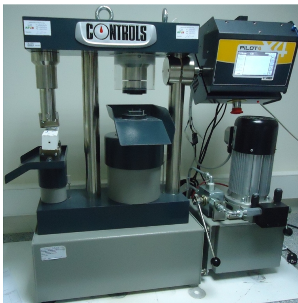
Figura 19: Equipamento para a realização de ensaios de resistência à flexão e compressão.
