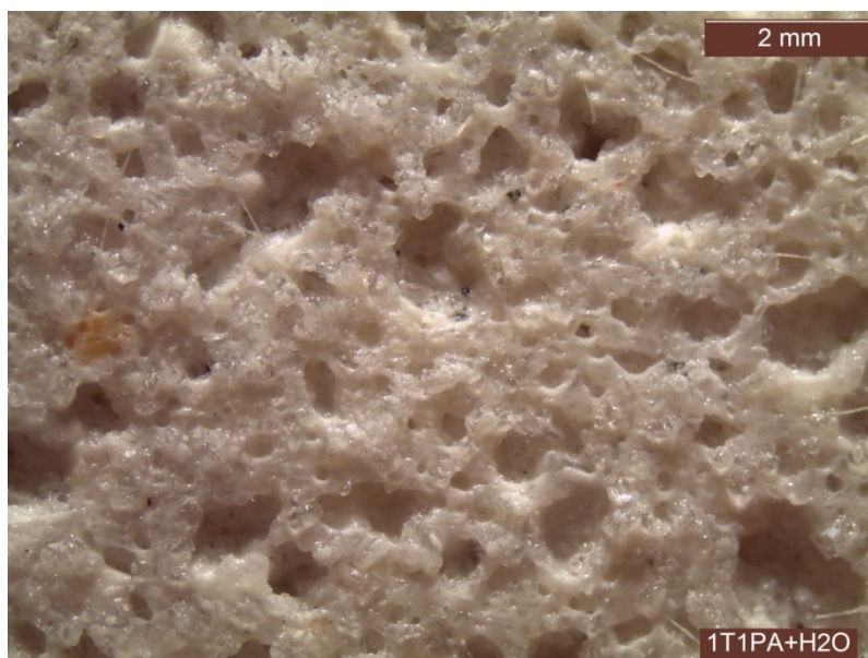
Figura 43: Superfície do provete 1T1PA que contactou com a água, observada numa Lupa Leica do modelo: EZ 4 HD.
