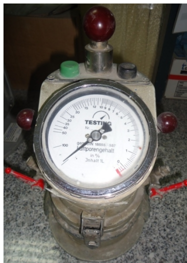
Figura 14: Equipamento utilizado para a medição da percentagem de ar.
