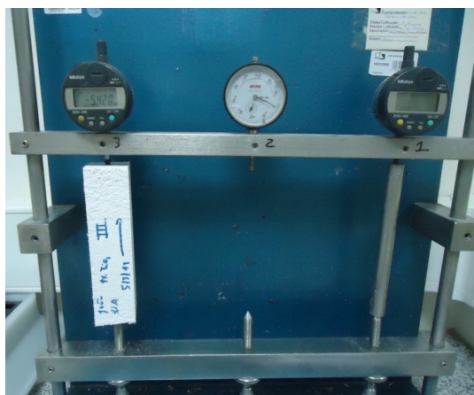
Figura 17: Micrómetro utilizado para medir as variações dimensionais.
