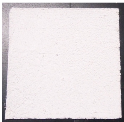
Figura 28: Placa colocada no interior do reator para o ensaio fotocatalítico.
