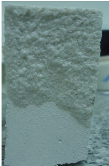
Figura 46: Imagem da amostra de 1PA20PCM ensaiada à capilaridade e revelando inchamento superficial.
