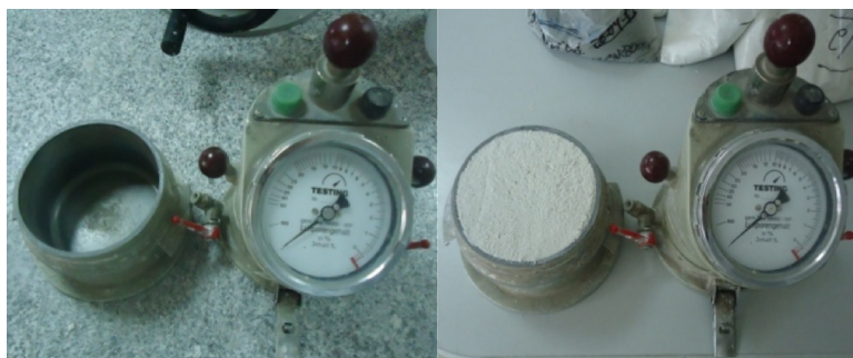
Figura 15: Equipamento para medição da percentagem de ar sem e com argamassa respetivamente.
