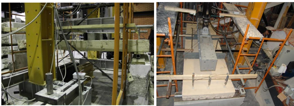
Figura 6.4 Início do ensaio das lajes após instrumentação.
