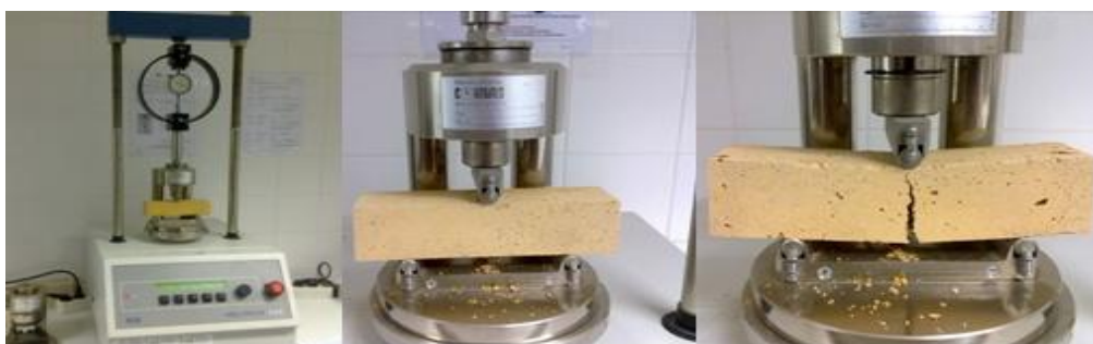
Figura 3.10 Ensaio de tração por flexão na prensa hidráulica.
