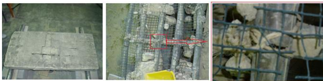
Figura 5.3 Laje de teste invertida após o ensaio e rompimento de uma das armaduras observado após destruição.
