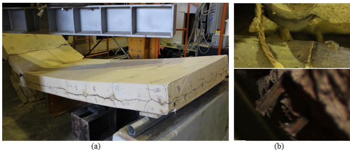
Figura 6.9 Laje L2: a) – colapso da laje pelo lado mais danificado, b) – corte nas ligações e arrancamento dos conectores por esforço transverso
