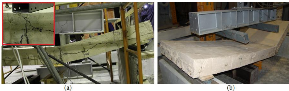
Figura 6.12 Laje L3: a) – ligeiro esmagamento da terra e subida de fissura longitudinal no encontro com vertical na secção 2, b) – colapso da laje por um dos planos de aplicação de carga (secção 2).
