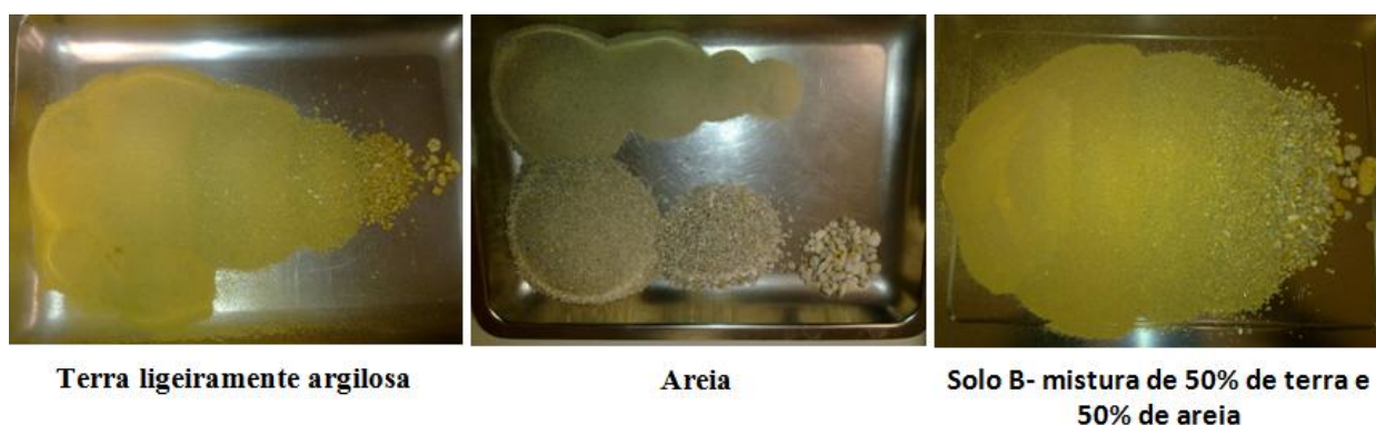
Figura 3.5 Agregados da terra (esquerda), da areia (no centro) e do solo B resultante da mistura da terra e areia em partes iguais.
