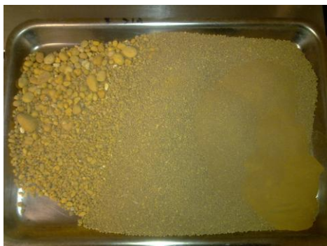
Figura 3.2 Agregados do solo após separação por peneiração.
