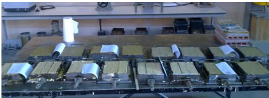
Figura 3.9 Diferentes argamassas nos moldes prismáticos (40×40×160)mm.
