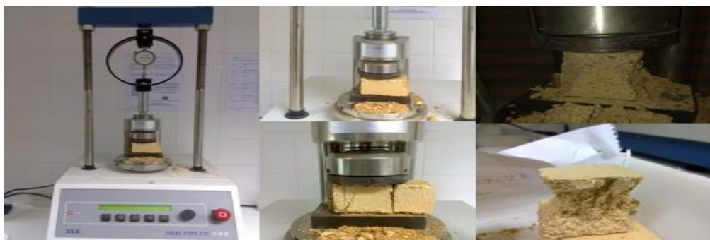
Figura 3.11 Ensaio à compressão simples e configuração dos provetes depois de ensaiados.
