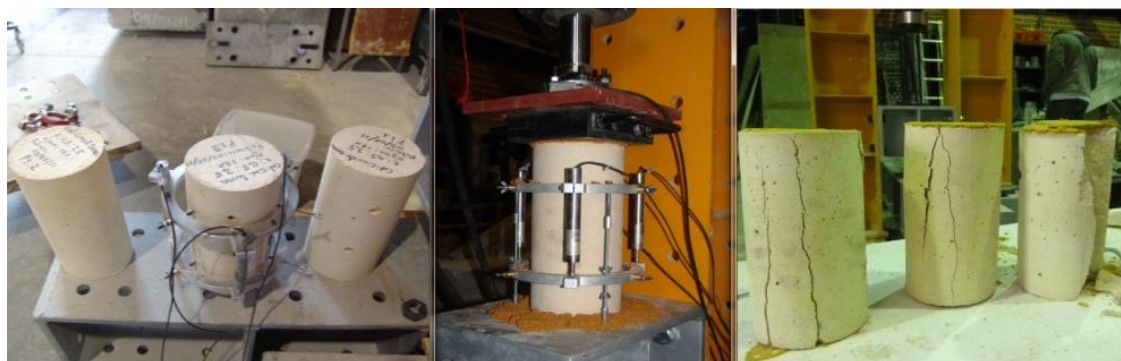
Figura 3.16 Ensaio de compressão de provetes cilíndricos.
