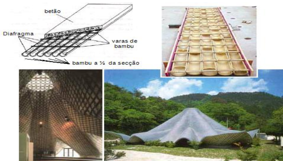
Figura 2.6 Bambu como elemento de reforço e como forma permanente em laje de betão.
