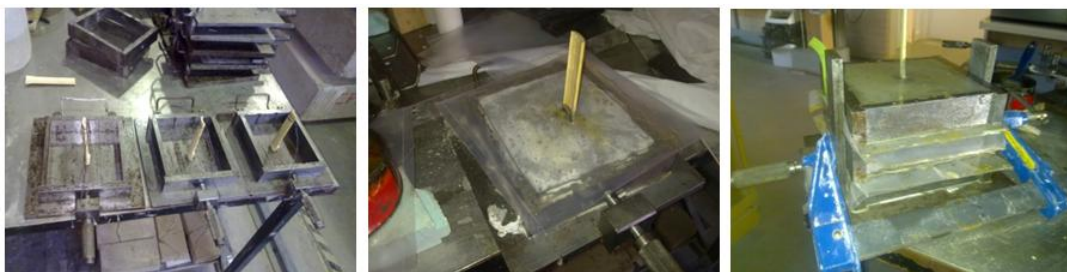
Figura 3.31: Produção dos provetes para ensaio de corte transversal do bambu.
