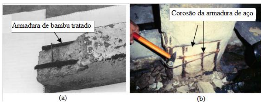
Figura 3.28 (Ghavami b 2005) comparação da durabilidade de reforço de bambu, a) - após 15 anos em exposição ao ambiente e, b) - do aço após 10 anos em aérea fechada.
