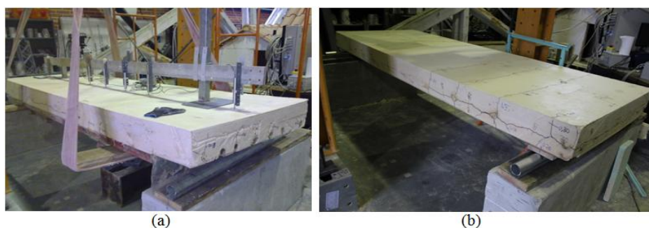
Figura 6.2 a) – fixação da laje L3 nos apoios para remoção da cofragem inferior; b) - laje L2 fixa sobre os apoios e pronta para montagem do sistema de ensaio.
