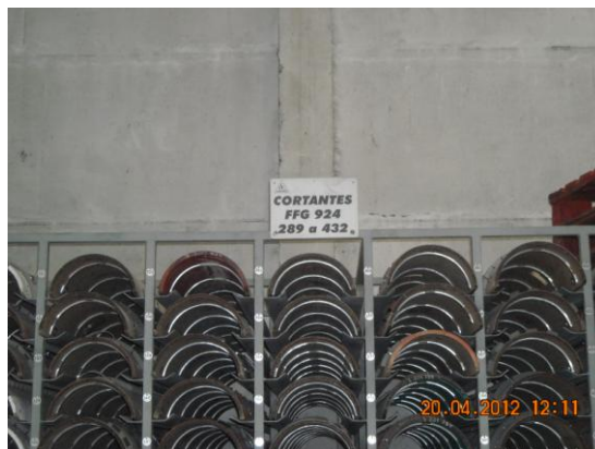
Figura 43 – Armazenamento dos cortantes da máquina.
