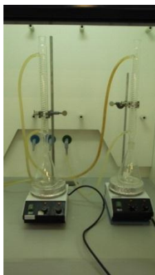
Figura 2.7- Montagem usada na determinação do CQO
