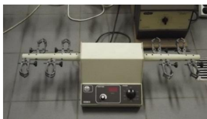
Figura 2.4- Agitador de braços usado na determinação da viscosidade intrínseca das diferentes pastas
