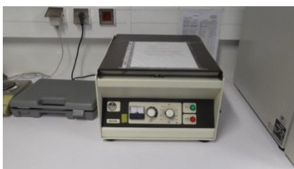
Figura 2.8- Centrífuga usada na determinação da reatividade da pasta final
