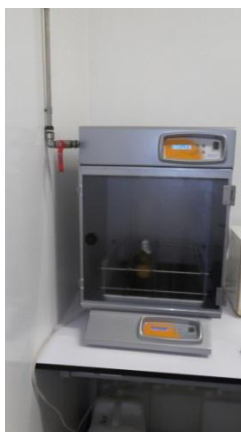
Figura 2.9- Shaker mecânico com o frasco de vidro com a suspensão de alcalicelulose durante o período de agitação de 3 horas
