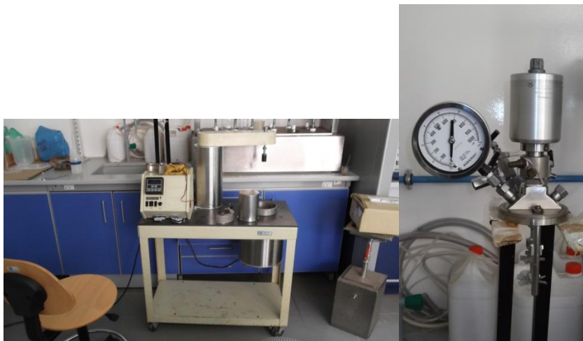
Figura 2.2- Reator Serie 4581 e controlador Serie 4842 (à esquerda) e veio de agitação (à direita)
