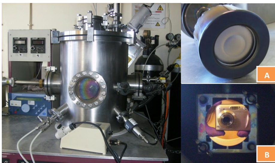
Figura 9 – Equipamento de pulverização catódica por magnetrão utilizado na deposição dos filmes de Al 2 O 3 e de Fe e respectivo magnetrão com alvo de Fe (A) e porta substratos com substrato de Si/SiO 2 já revestido com os filmes (B).
