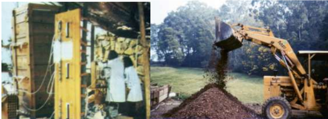
Figura 2.2 - Sistema de compostagem em reator e formação de uma pilha estática
