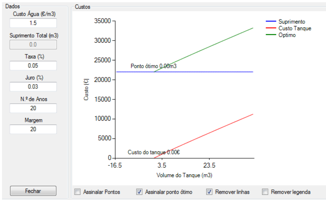
Figura 54 – Otimização do dimensionamento do volume de reservatório Grândola
