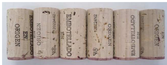
Figura 4.44- Rolhas naturais submetidas ao ensaio de capilaridade, tratadas com PS+OS.
