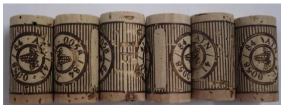
Figura 4.28 – Rolhas naturais submetidas ao ensaio de capilaridade, tratadas com EP+OS.
