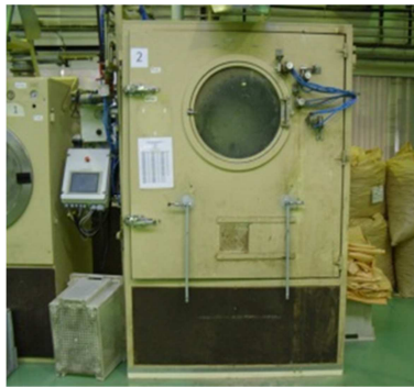
Figura 1.16 – Equipamento utilizado no tratamento de superfície de rolhas de cortiça.
