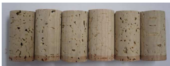
Figura 4.48 – Rolhas naturais submetidas ao ensaio de capilaridade de amostras naturais, tratadas com EP+OS numa máquina de revestimento de medicamentos.
