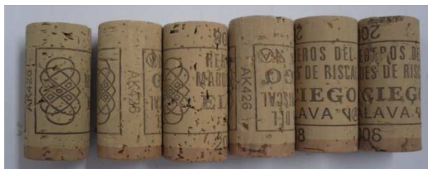
Figura 4.36 – Rolhas naturais submetidas ao ensaio de capilaridade, tratadas com F3.
