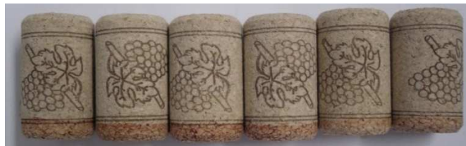
Figura 4.32 – Rolhas Neutrocork ® submetidas ao ensaio de capilaridade, tratadas com ELS.
