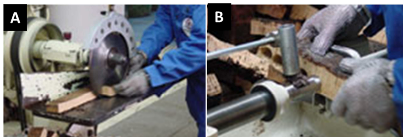
Figura 1.13 – Produção de rolhas de cortiça: rabaneação (A) e brocagem (B).
