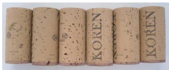
Figura 4.40 – Rolhas naturais submetidas ao ensaio de capilaridade, tratadas com EP+OS.
