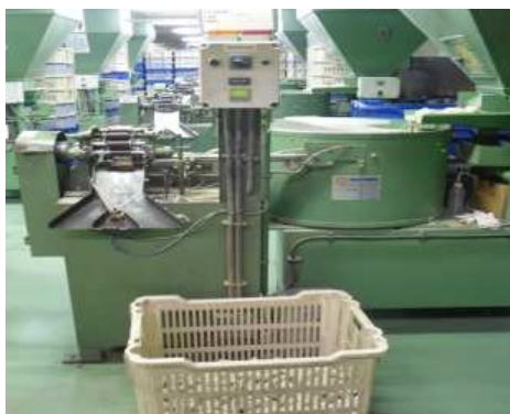
Figura 1.15 - Produção de rolhas de cortiça: marcação a tinta.
