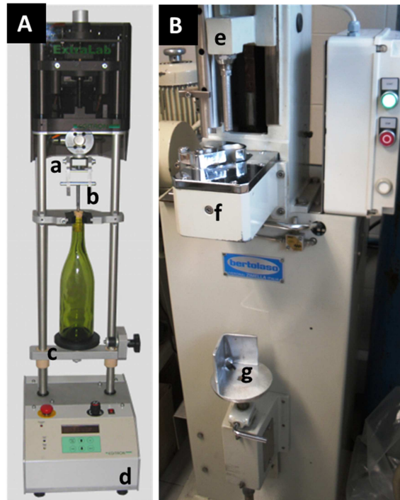
Figura 3.1 – Equipamentos utilizados nos ensaios de forças de extração: Extralab da Egitron (A) e Rolhadora Epsilon R/S , da Bertolaso (B). Legenda: a - cabeça de extração, b – saca-rolhas, c /g – suporte para a garrafa, d – comandos de controlo, e – pistão, f – câmara da maxila.
