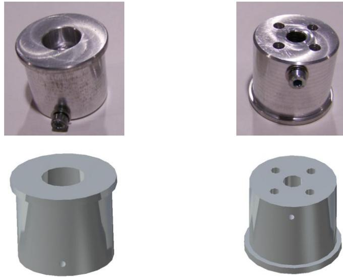
Figura 25 - Adaptador para a roda traseira (produto final e desenho 3D)
