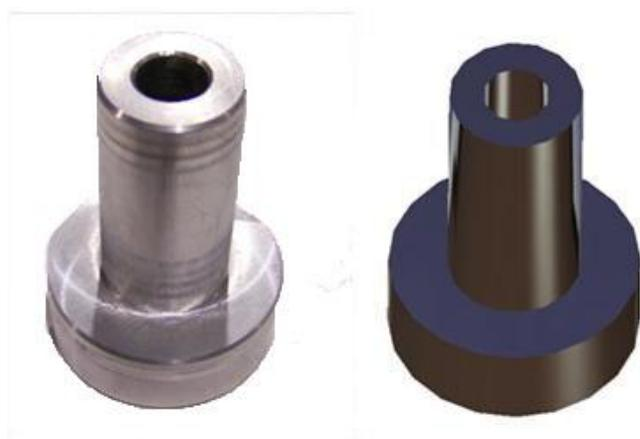
Figura 23 - Adaptador para a roda dianteira (produto final e desenho 3D)
