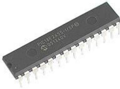
Figura 33 - Microcontrolador PIC18F2455
