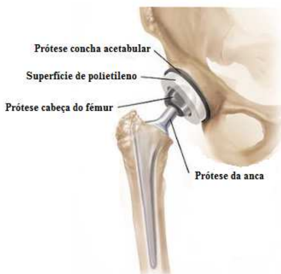
Figura 4 – Componentes de uma prótese usada numa ATA (adaptado [10]).
