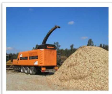
**Figura 13 – Estilhaçadora de grandes dimensões em parque de pré-tratamento (fonte: Enersilva, 2007).**
