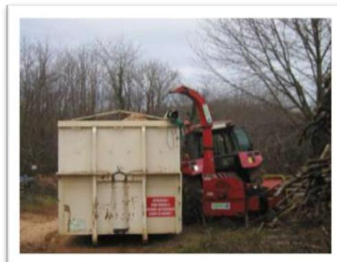
**Figura 12 - Estilhaçador móvel (fonte: Enersilva, 2007).**
