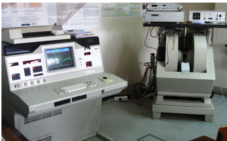
Figura 7 - Espectrómetro EPR (Bruker ESP 300) utilizado na medição das doses absorvidas pela alanina, do Departamento de Física da Universidade de Aveiro.
