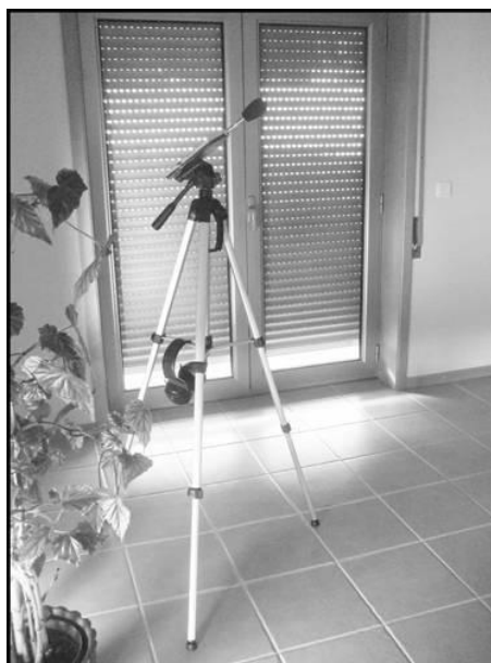
Figura 15 - Sonómetro posicionado para medição do ruído de fundo
