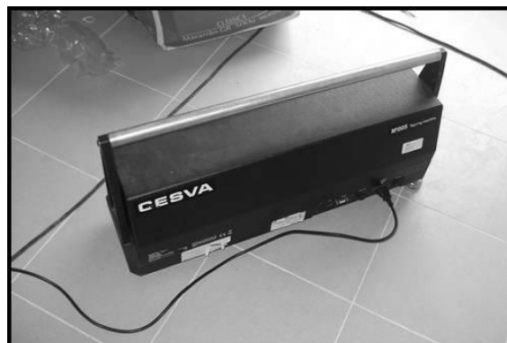
Figura 18 - Máquina de martelos usada na medição dos sons de percussão entre compartimentos
