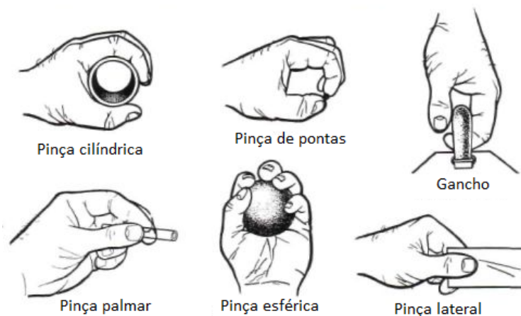
Figura 2.24: Classificação dos tipos de preensão segundo Schlesinger [fonte: Digital Resource Foundation http://www.oandplibrary.org/popup.asp?frmltemId=9E3358AC-9E14-475E-B3B0-D829C19CF103&frmType=image&frmId=13 ]
