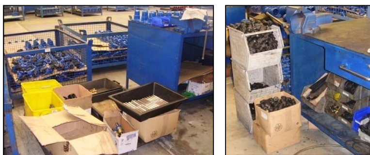
Figura 22: Desorganização no posto de trabalho evidenciando a ausência de equipamentos de arrumação específicos para linhas de montagem.
