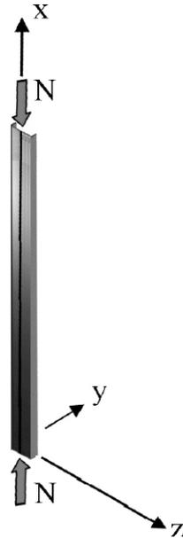
Fig. 5.7 - Pilar sujeito à compressão
