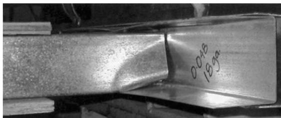
Fig. 4.5 - Colapso da alma junto ao apoio (Veríssimo, 2008)
