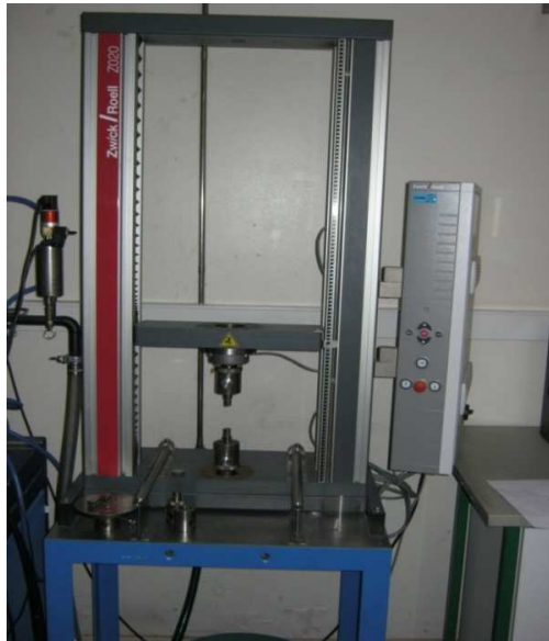
Figura 33- Equipamento utilizado para o ensaio de tração uniaxial.
