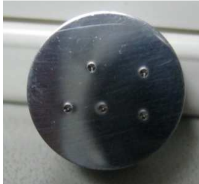
Figura 30 – Aspeto de um provete do aço 1.2344 após o ensaio de dureza Rockwell C.
