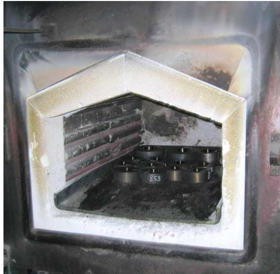
Figura 10 - Forno de aquecimento dos anéis de aço para embutimento a quente.
