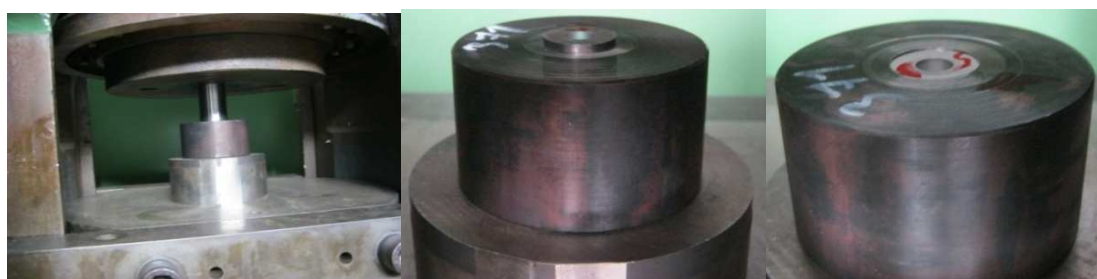
Figura 14 – Etapas do ciclo de embutimento a frio.
