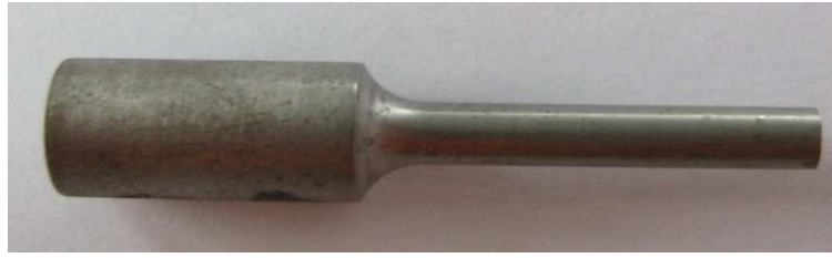
Figura 47 - Provete do aço 1.2379 61,4HRC após o ensaio de tração.
