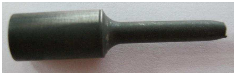
Figura 40 – Provete do aço 1.2344 48,6HRC após o ensaio e tração.
