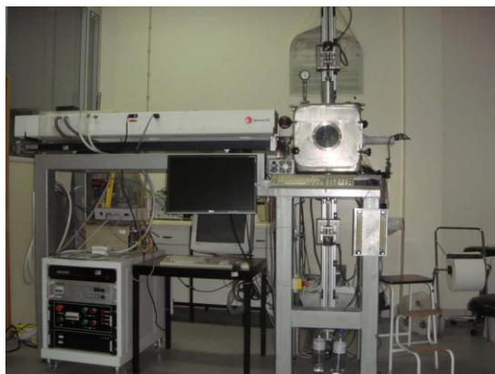
Figura 10 - Equipamento de fusão de zona com laser do Departamento de Física da Universidade de Aveiro, onde foi realizado este trabalho.
