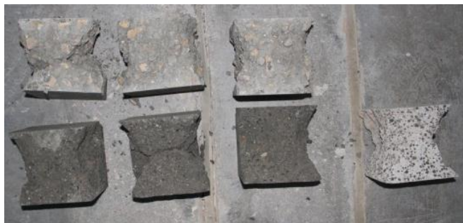
Figura 27 Fotografia de provetes de betão corrente (em cima) e de betão leve (em baixo) ensaiados à compressão para o terceiro dia de idade. O provete do lado direito em baixo é um provete de betão leve já curado.
