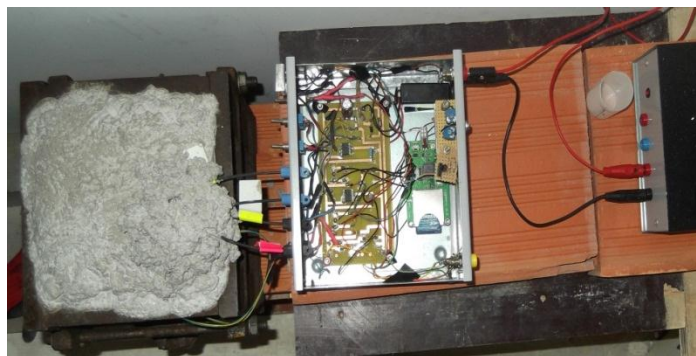
Figura 16 Protótipo de aquisição em funcionamento, Conbox .
