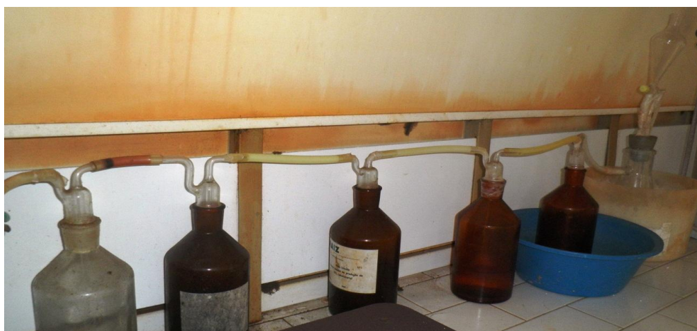
Figura 2.4 - Montagem experimental para a produção de dióxido de cloro.
