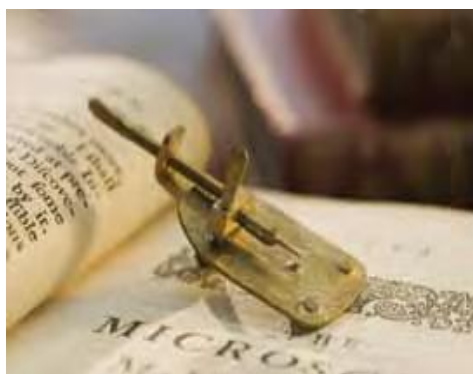
Figura 7: Réplica de um dos microscópios de luz feito por Antony van Leeuwenhoek. Retirado de FEI Company, (2010).
