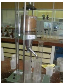
Figura 2.1: Aparelho de medição do grau Schopper-Riegler (°SR)
