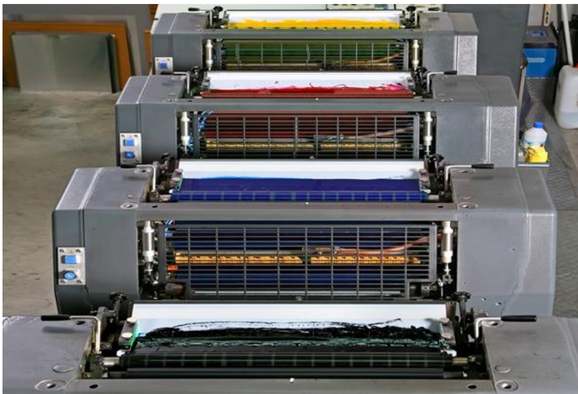
Figura 6 - Unidades de Impressão Offset – Diferentes cores - CMYK (rioGráfica, 2010).
