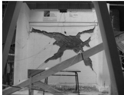
Figura 9. Danos observados (estado final) nas faces Norte e Sul da parede
