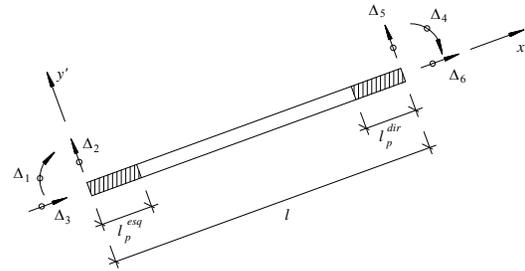
Fig. 2. Frame macro-element [Varum, 1996]
