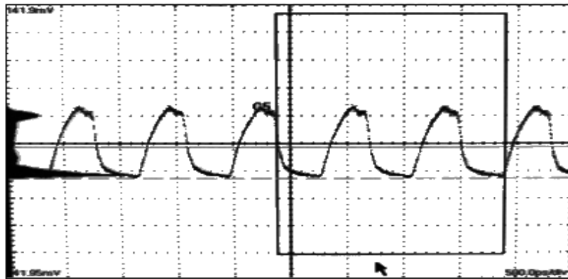
Figura 5.16 – Resposta da porta lógica óptica para um sinal modulado a 1.244 GHz.
