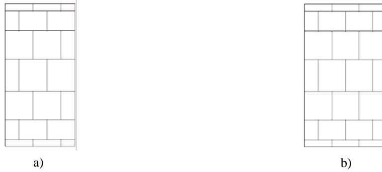
Figura 7. Planta de um arco com diferentes opções de assentamento: a) um meio bloco por fiada; b) dois meios blocos em fiadas intercaladas.
