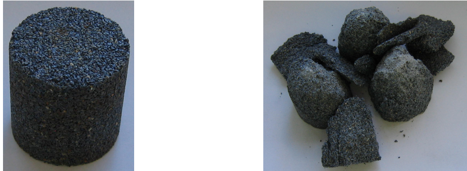
Figura III.14. Fotografia exemplificativa de uma amostra usada no ensaio de compressão.
