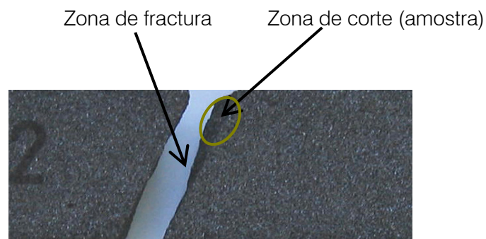
Figura II.2. Fotografia representativa da zona de corte para análise microestrutural.
