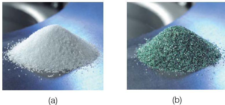
Figura I.4. (a) Fotografia de partícula de alumina; (b) Fotografia de partículas de carboneto de silício.
