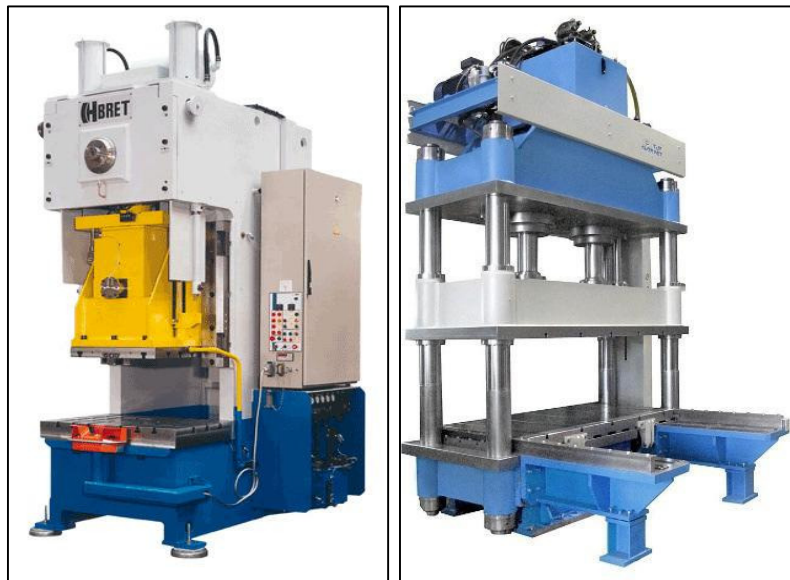
Fig. 62 – Prensa mecânica de estrutura em C [16], e prensa hidráulica de estrutura em arcada [15].
