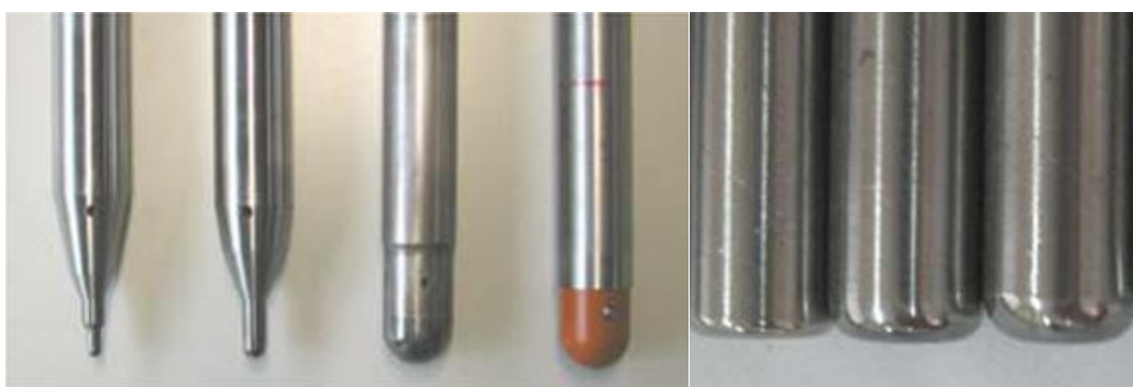
Fig. 29 – Punções de ponta esférica (esq.) e de ponta plana (dir.) usados em ISF [JES2005a].
