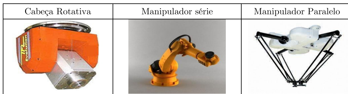
Fig. 32 - Sistemas cinemáticos com seis graus de liberdade: cabeça rotativa de CNC [1], manipulador série [2], e manipulador paralelo [3].
