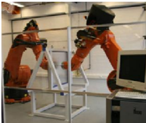
Fig. 16 - Estampagem incremental com ferramentas em oposição realizada por dois braços robóticos [MEI2009].
