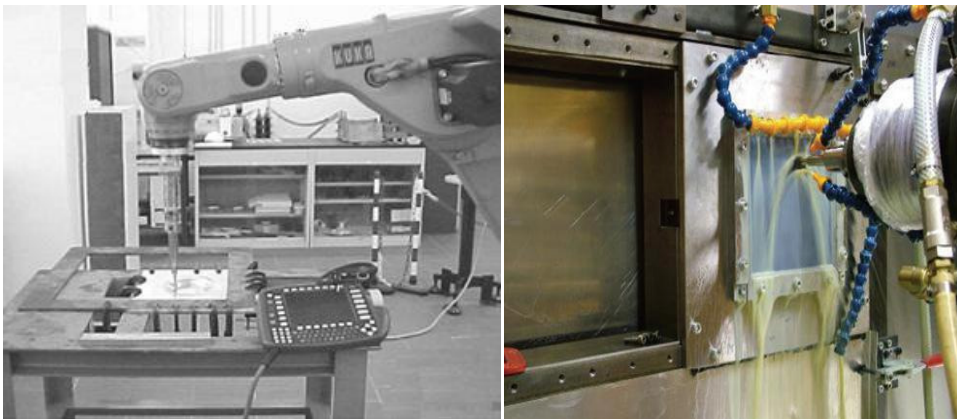
Fig. 15 - Braço robótico a realizar estampagem incremental na horizontal [STR2005], e na vertical [DUF2007].
