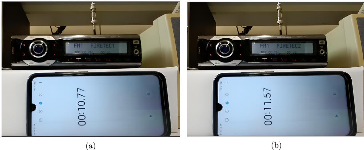
Figura 4.19: Captura de ecrã do recetor, junto com o cronómetro, em dois momentos temporais distintos: a) No exato momento em que ocorre a perda de cobertura; b) Imediatamente após a comutação.
