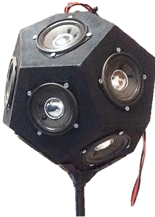
Figura 3.7: Coluna omnidirecional dodecaédrica desenvolvida.
