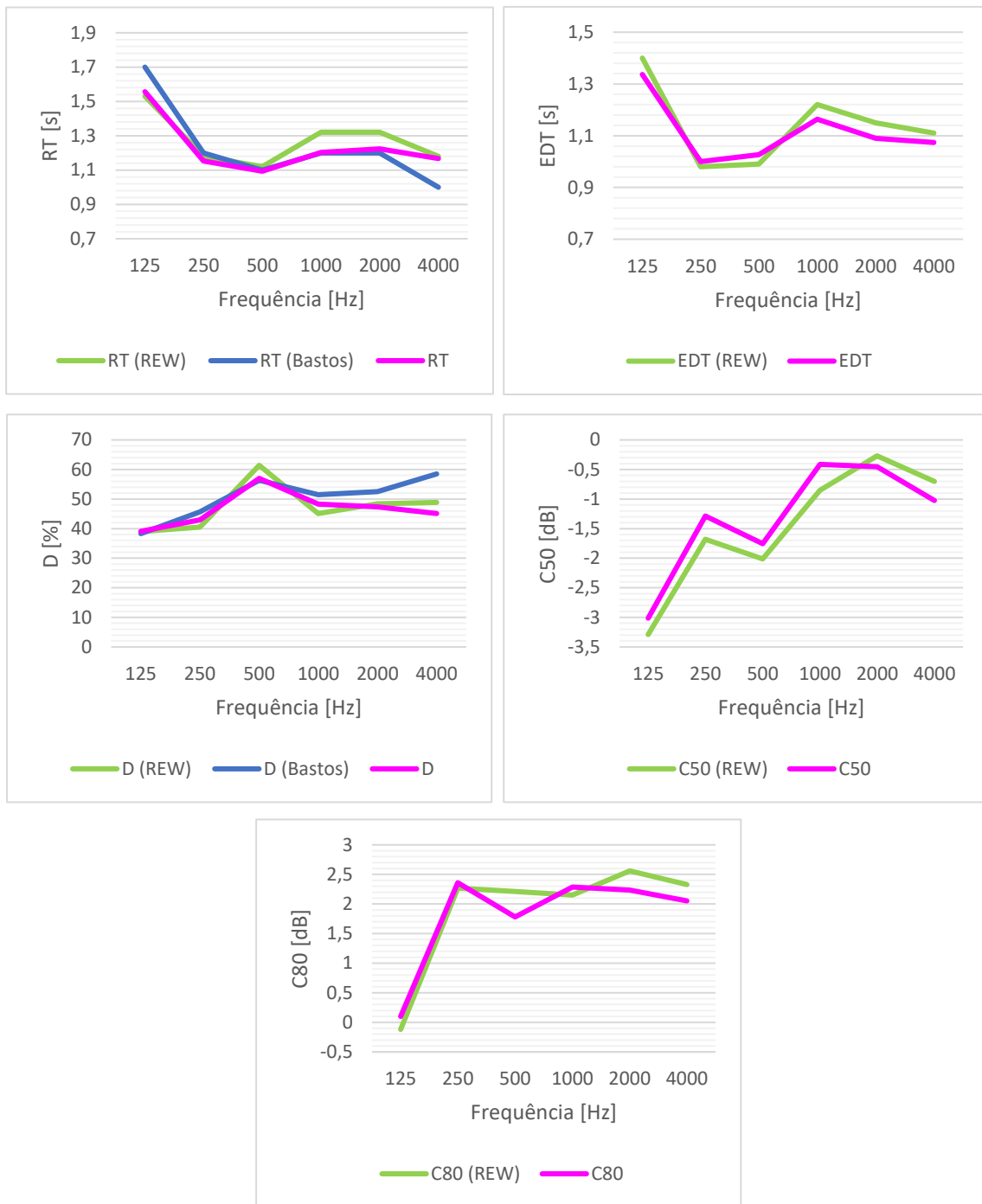
Figura 5.14: Comparação dos parâmetros acústicos medidos com kit desenvolvido com as medições efetuadas com o software REW e, quando possível, com as medições efetuadas em [50], para o Auditório José Grácio. Os parâmetros comparados são RT (em cima à esquerda), EDT (em cima à direita), D (no meio à esquerda), C 50 (no meio à direita) e C 80 (em baixo).
