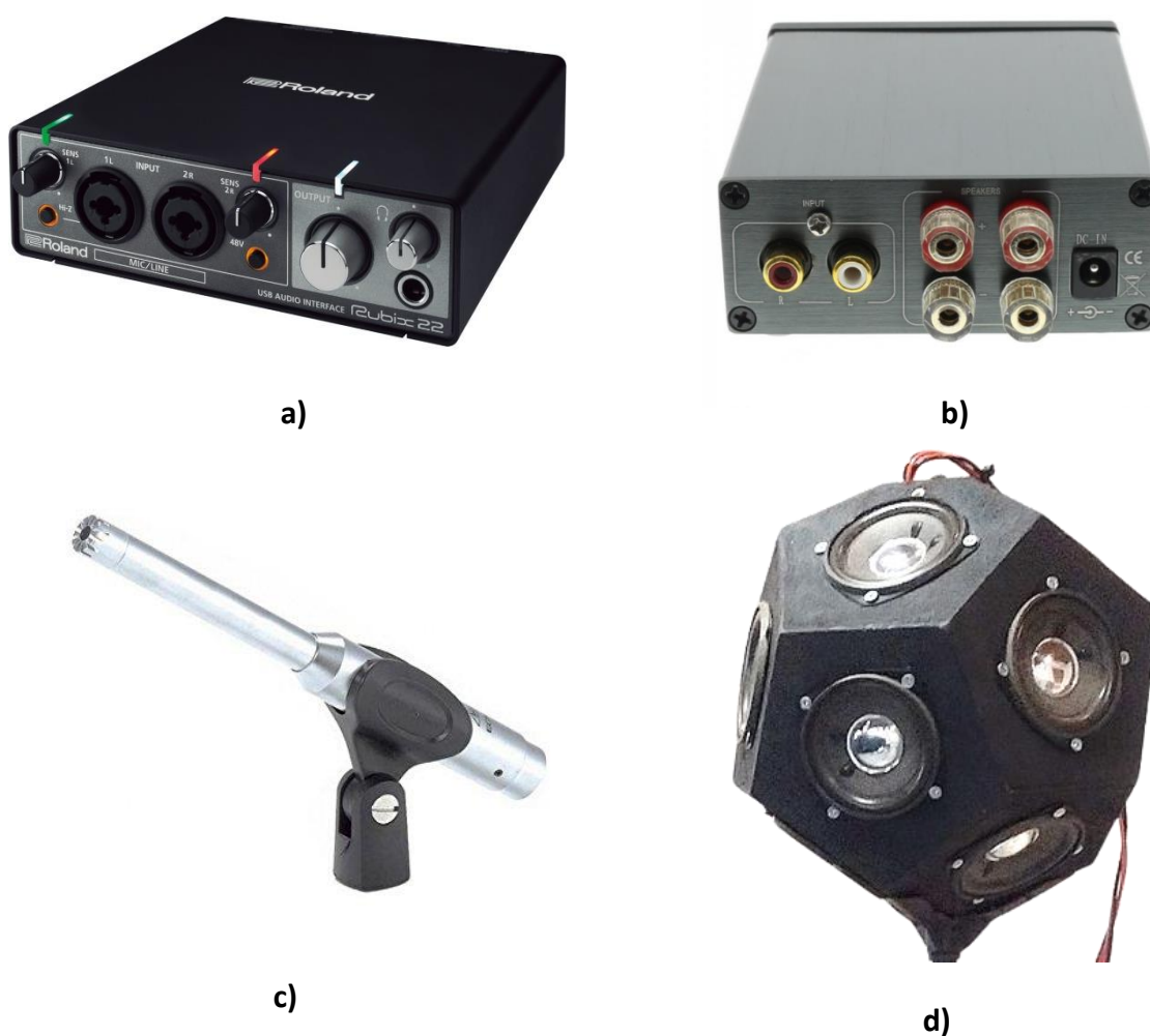
Figura 5.1: a) Placa de som Rubix22 da marca Roland, b) Amplificador TPA-S25 da marca Audiphonics, c) Microfone de medição EMC8000 da marca Behringer, d) Coluna omnidirecional dodecaédrica desenvolvida neste trabalho.
