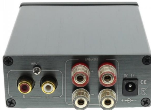
Figura 3.8: Vista traseira do amplificador de 2 canais Audiphonics TPA-S25.
