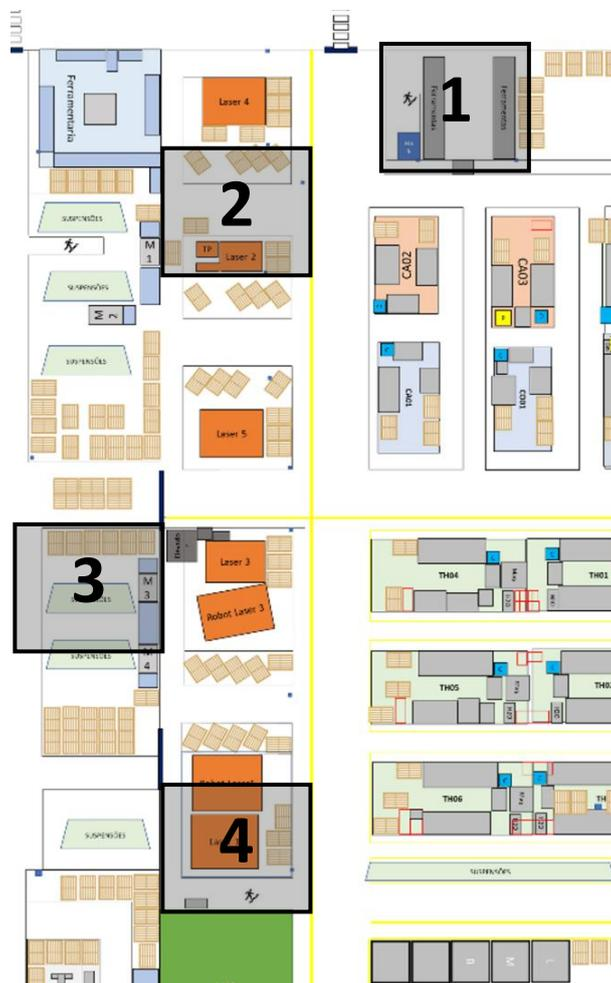
**Figura 31:** Representação das zonas de armazenamento de ferramentas
