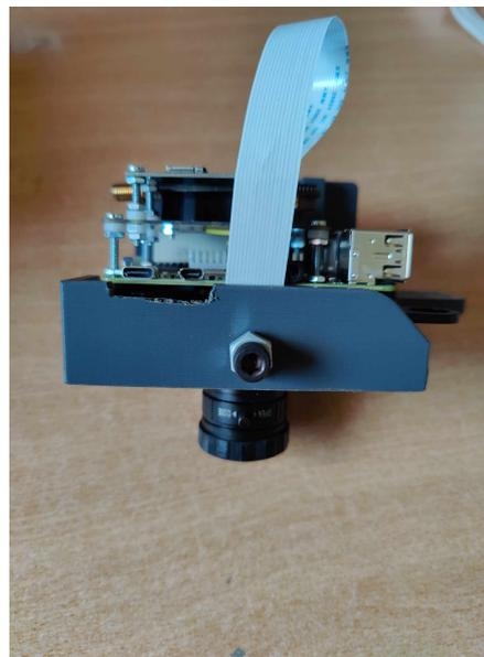
Figura 4.41: Sistema HAT RPi4 e PCB integrados c/ os sensores (2).
