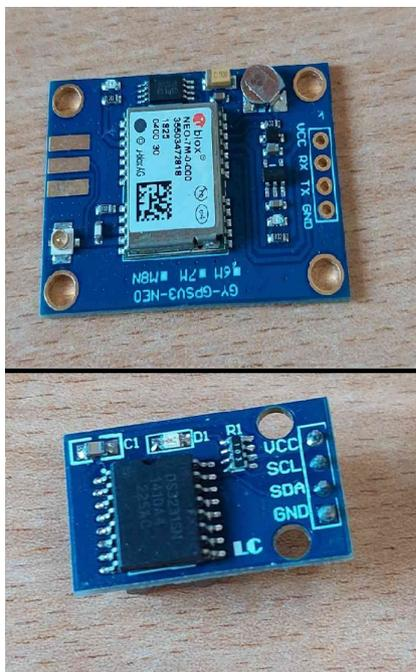
Figura 4.42: Módulo RTC e GPS.
