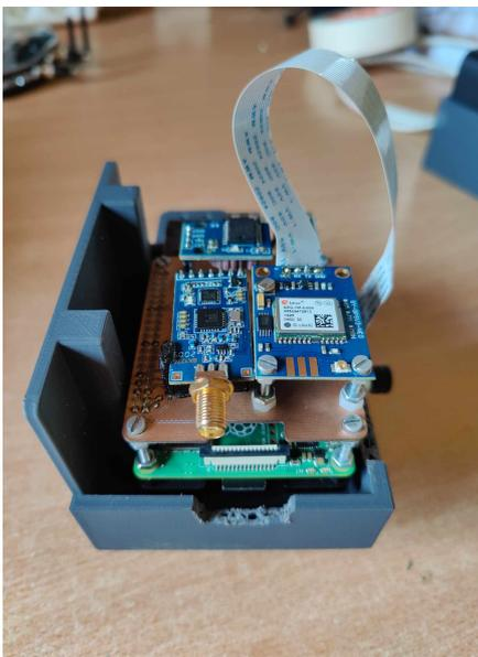
Figura 4.40: Sistema HAT RPi4 e PCB integrados c/ os sensores (1).
