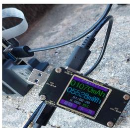
Figura 4.37: Medidor de tensão e corrente.
