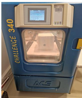
Figura 4.38: Equipamento para o teste de temperatura.
