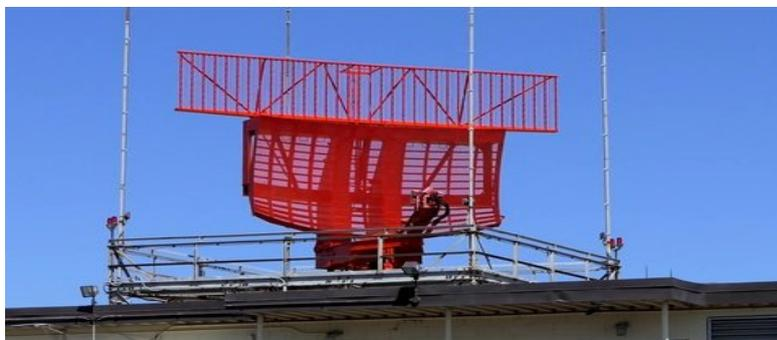
Figura 2.17: Radar ASR-9.
