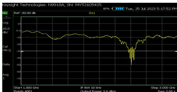
Figura C.3: Medição  $S_{11}$  antena da *ground segment* 4.22 (1).
