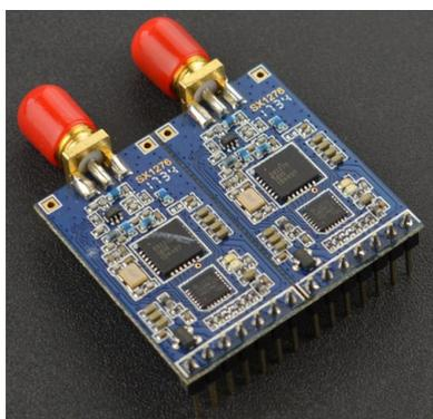
Figura 4.44: Módulo LoRa - 868MHz.
