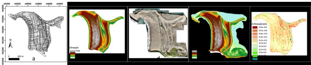
Figura 1. Levantamentos de abril 2019: a) grelha de observações terrestres e b) MDS resultante, c) ortomosaico e d) MDS do levantamento com VANT, e) diferenças de elevação calculadas c) menos b).
