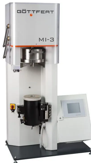
Figura 3.3: Plastómetro, modelo Göttfert MI-3 [54]
