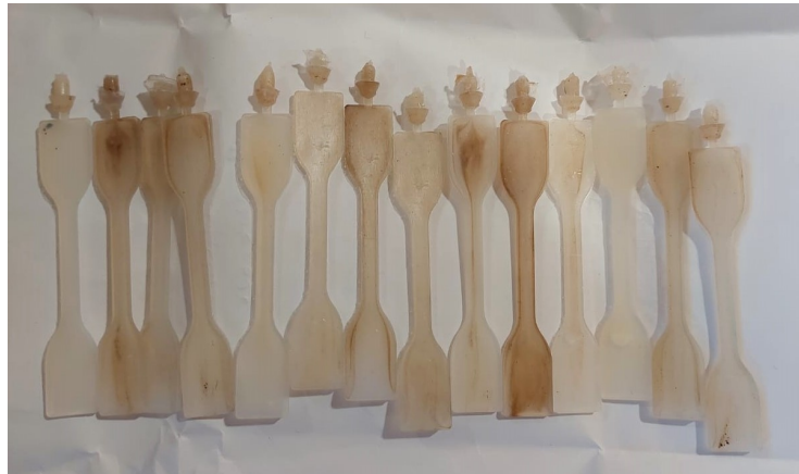
Figura 3.7: Provetes realizados na mini-injetora
