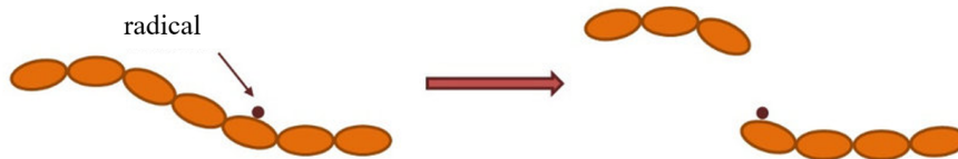
Figura 2.4: Ligação cruzada (a), quebra de cadeia (b). Adaptado de [37]
