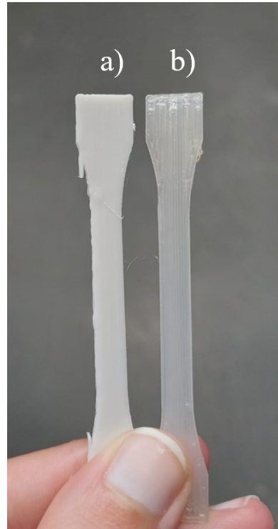
Figura 3.11: Provete 1BA obtido com o pó virgem (a) e pó rejeitado (b)
