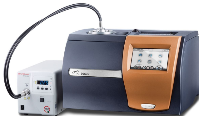
Figura 3.2: Calorímetro diferencial de varrimento, modelo TA Instruments-Discovery DSC250 [51]
