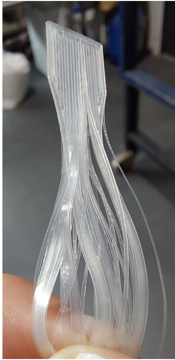
Figura 3.10: Provete com fraca aderência entre camadas
