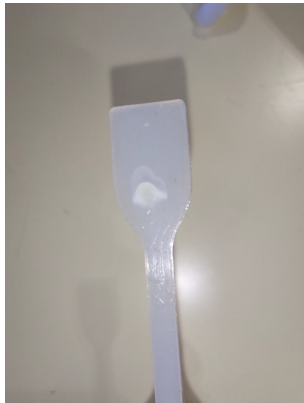
Figura 3.6: Provete com defeito
