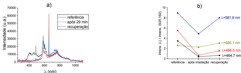
Figura 6.5 – Recuperação da transmissão ótica da fibra SOF-MM. Em a) estão representados os espectros de transmissão ótica da fibra antes (preto), no final de 29 minutos de irradiação (vermelho) e algum tempo após a irradiação parar (azul). Em b) é apresentada a razão entre a intensidade de um determinado comprimento de onda (afetado pela radiação) com a intensidade de outro de referência (não afetado pela irradiação de 925,162 nm) para a pré-irradiação (1º ponto), final da irradiação (2º ponto) e algum tempo após a irradiação parar (3º ponto-recuperação).
