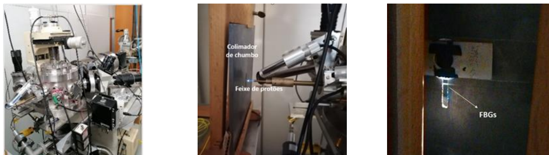
Figura 6.10 – Fotografia da montagem experimental usada na exposição das FBGs ao feixe de prótons (figura da esquerda e do meio) e parte de trás do colimador de chumbo onde estão colocadas as FBGs (figura da direita).
