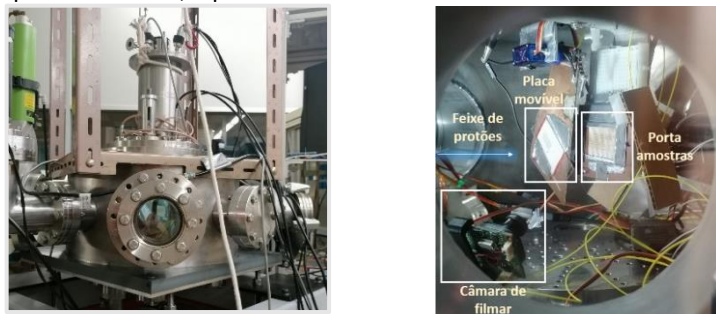
Figura 6.2 – Fotografias da montagem experimental no interior da câmara de vácuo onde foi realizada a irradiação.
