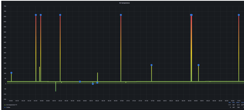
Figura 5.13: Outliers identificados pelo algoritmo durante o teste realizado em que não se inseriram outliers aleatórios
