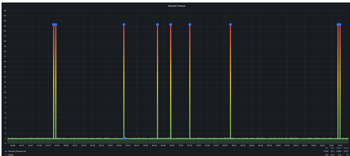
Figura C.3: Outliers identificados pelo algoritmo na série pressão hidráulica, durante o teste em que não foram gerados outliers aleatoriamente
