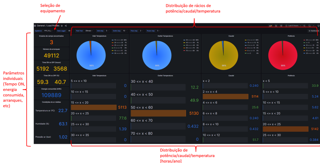
Figura 4.27: Dashboard com os perfis de carga, onde o utilizador poderá selecionar o tipo de equipamento do qual deseja visualizar os resultados e aplicar filtros aos ensaios de campo
