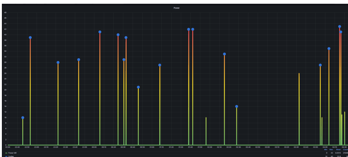
Figura C.1: Identificação de outliers na série temporal potência, onde foram gerados outliers aleatoriamente
