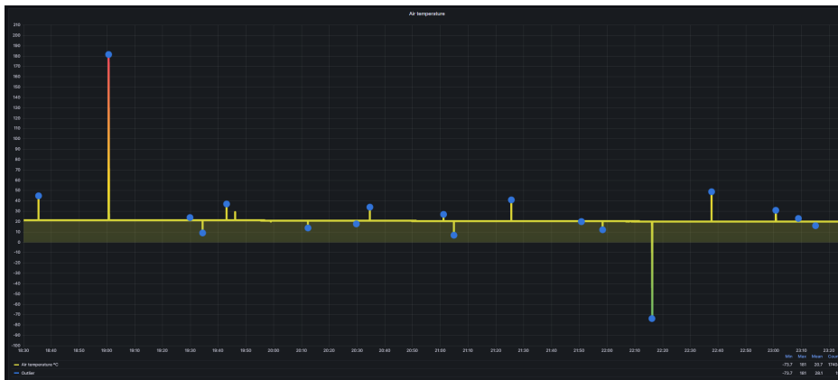
Figura 5.12: Identificação de outliers pelo algoritmo Isolation Forest para o primeiro teste realizado, gerando outliers aleatoriamente, para a temperatura ambiente
