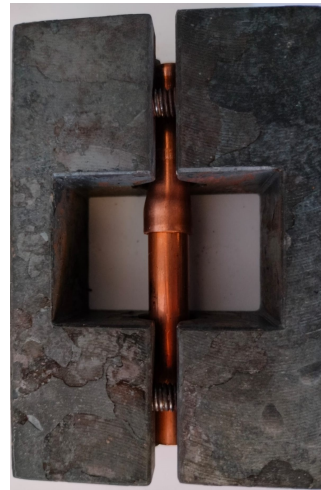
Figura 3.8: Colocação do tubo com anel interno no gabarito
