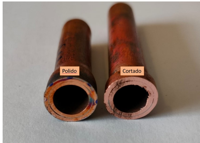
Figura 3.14: Diferença de aspeto entre tubos cortados e tubos polidos
