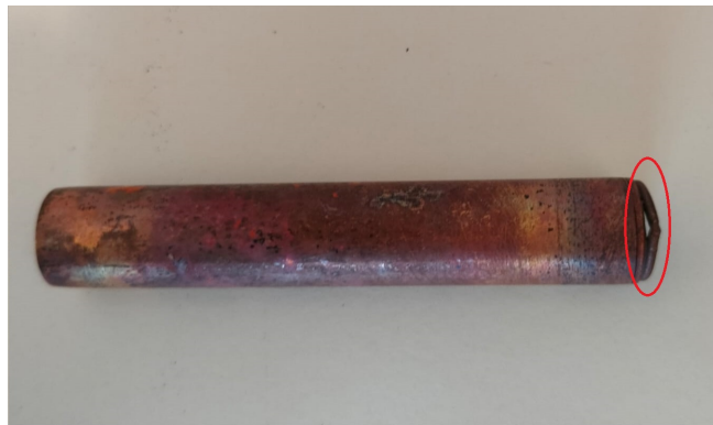
Figura 4.1: Fusão parcial do anel de adição
