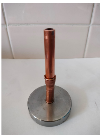
Figura 3.10: Gabarito utilizado na brasagem dos provetes
