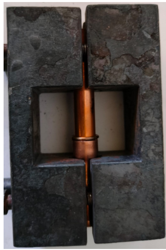
Figura 3.7: Colocação do tubo com anel externo no gabarito
