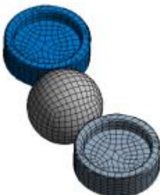
Figura 13 - Representação dos rolos com uma bola em fase de lançamento [1]
