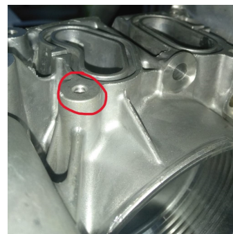
(f) Furo M6 não roscado na zona lateral do cárter
