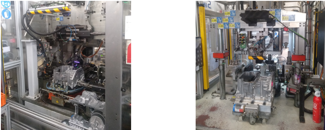
Figura 1.7: Processos de montagem (direita) e estanqueidade (esquerda) do cárter
