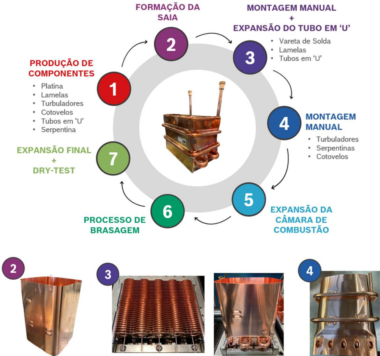
Figura 5 – Etapas principais do processo produtivo de uma CC
