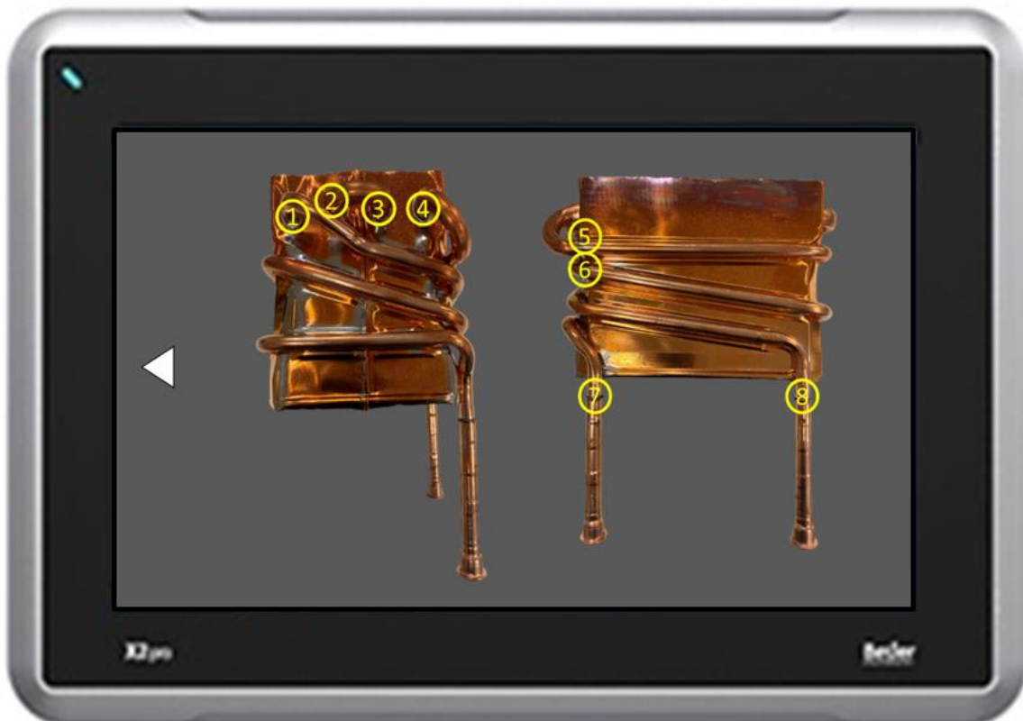
Figura 27 – Suporte visual com a localização de cada tipo de fuga de uma CC "Compact4 10L"
