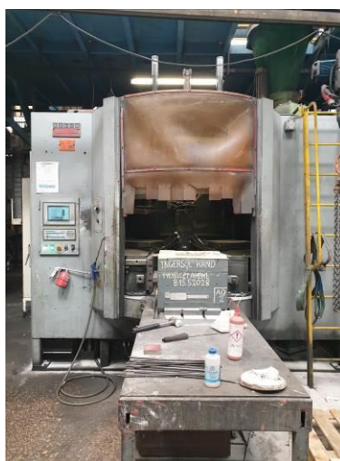
Figura 14 - Exemplo de máquina de produção de machos (Bicolor)
