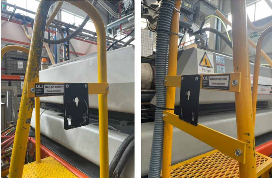
Figura 54 - Suportes criados para colocar a mão do robot antes e após a troca
