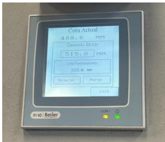
Figura 59 - Dispositivo de afinação automática implementado na MIP44
