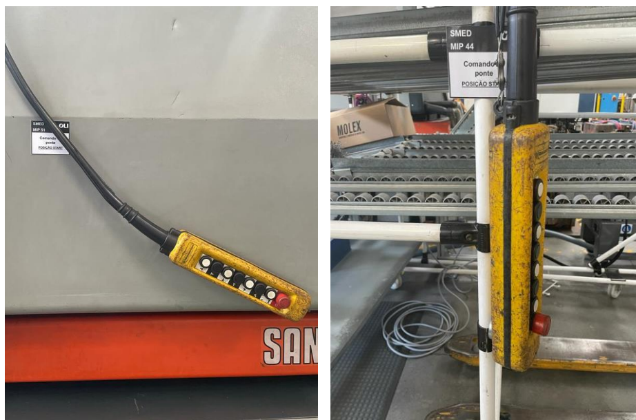
Figura 53 - Definição e identificação da posição standard para o comando da ponte
