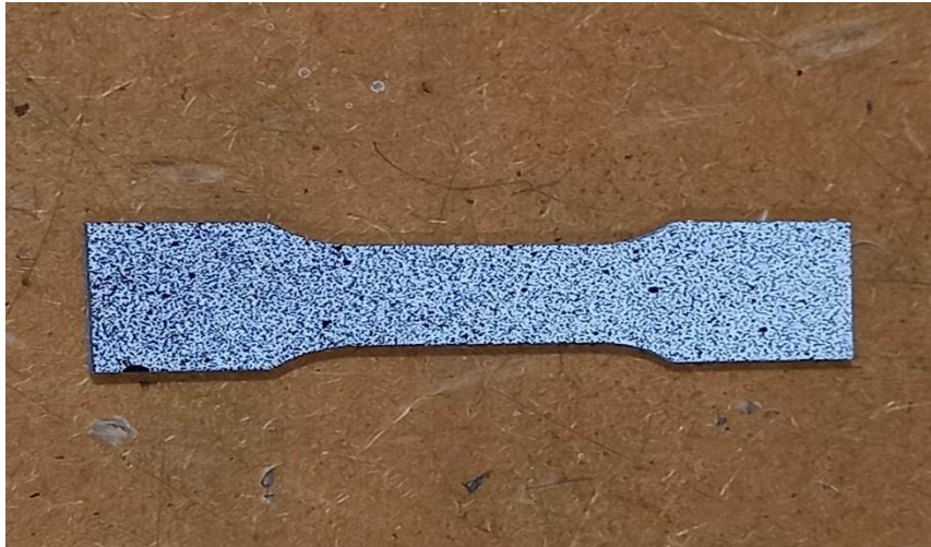
Figura 3.12 – Provete pintado de acordo com o padrão 65x52mm
