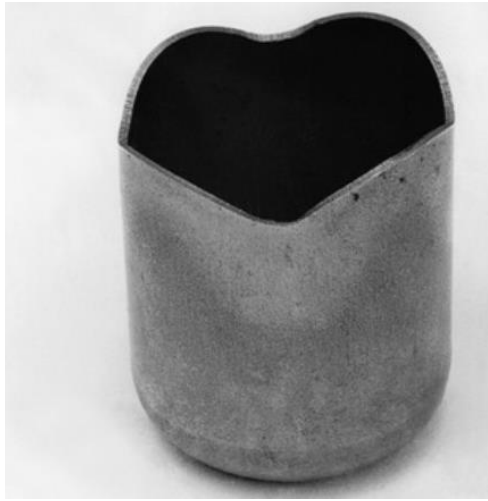
Figura 2.17 - Exemplo de “orelhamento” de um material devido à sua anisotropia planar (adaptado de [30])
