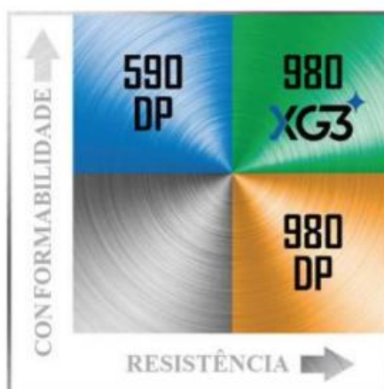
Figura 2.7 – Comparação entre o aço CR980XG3 e aços Dual-Phase em termos de conformabilidade e resistência (adaptada de [15])
