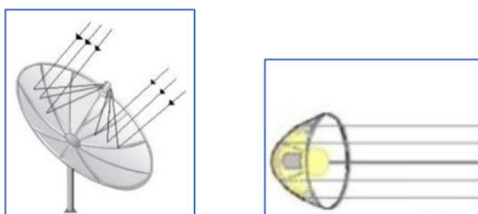
Figura 14: Esquema de antena parabólicas e de farol
