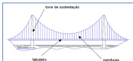
Figura 15: Esquema de ponte suspensa
