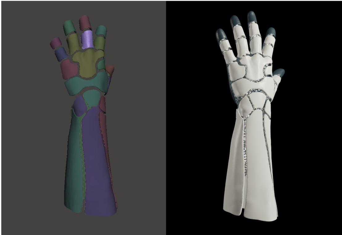
Fig. 194. Transformação do desenho 2D para uma forma rudimentar em 3D
