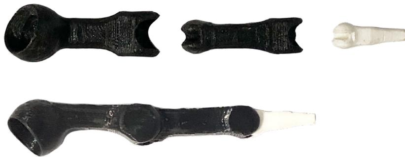
Fig. 133. Resultado do ensaio físico. Nesta figura é possível observar a sequência de montagem das peças.
