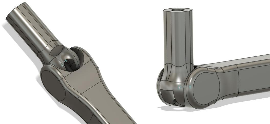
Fig. 131. Foi possível analisar no cad que esta guia alinhava ambas as peças , passando a ser uma articulação com 1 grau de movimento. Também foram adicionados batentes à guia para evitar hiperextensões.
