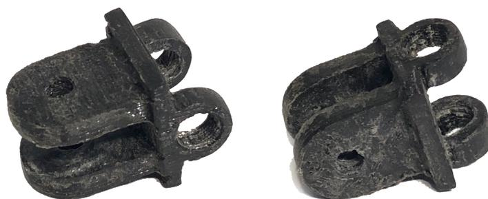
Fig. 84. 1.º teste de impressão 3D do pulso
