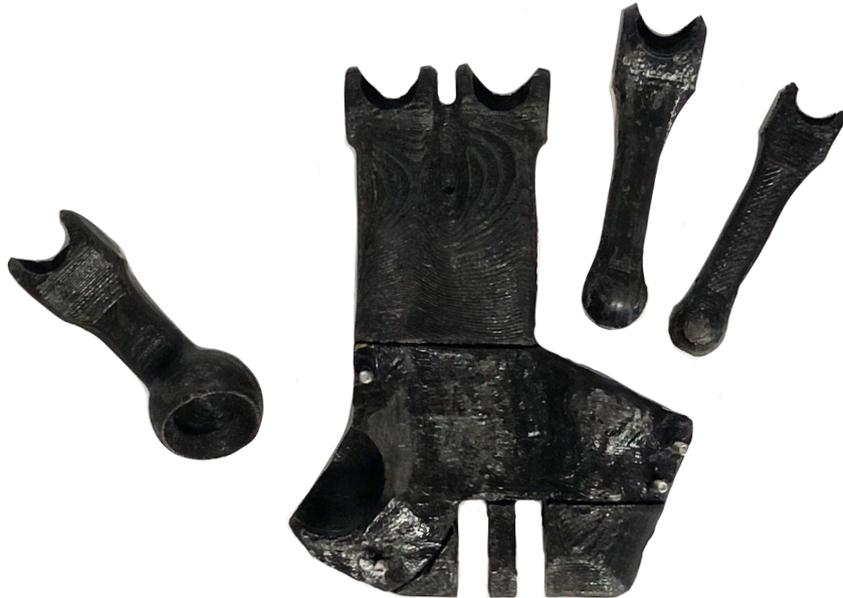
Fig. 106. 2º teste de impressão da palma e metacarpos
