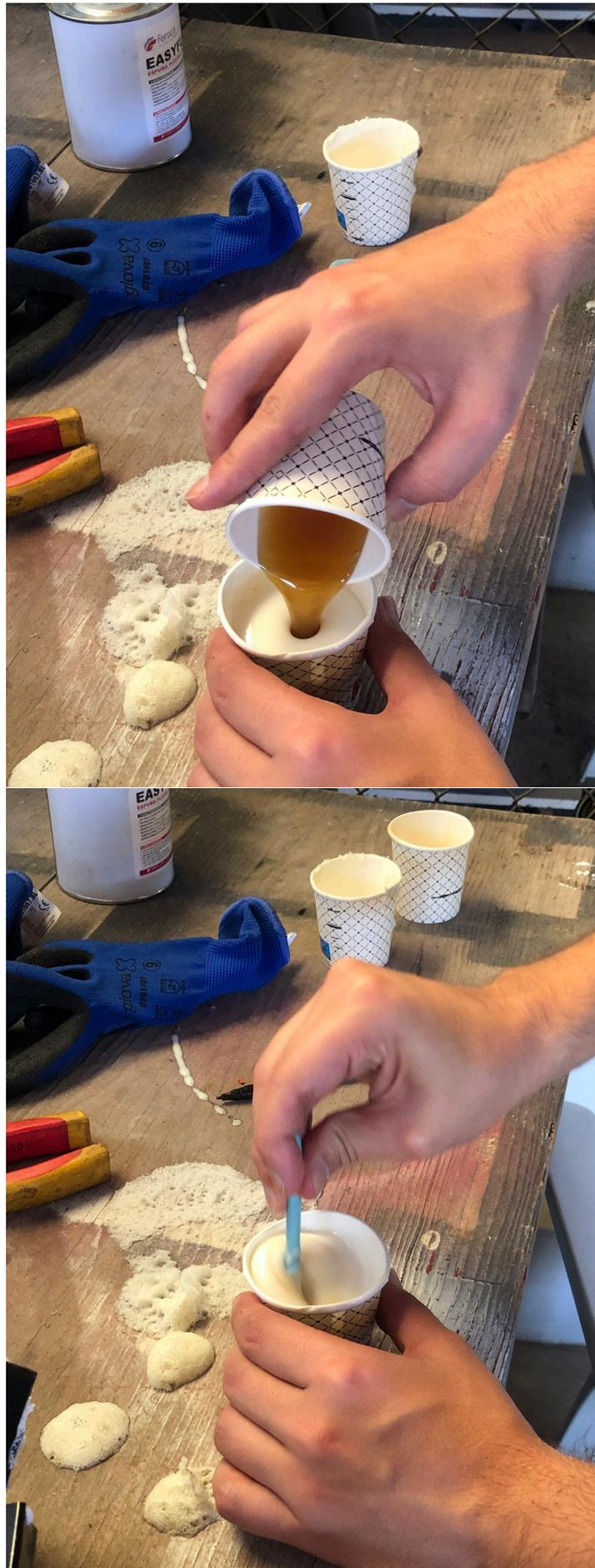
Fig. 156. Junção de ambas as partes no molde
