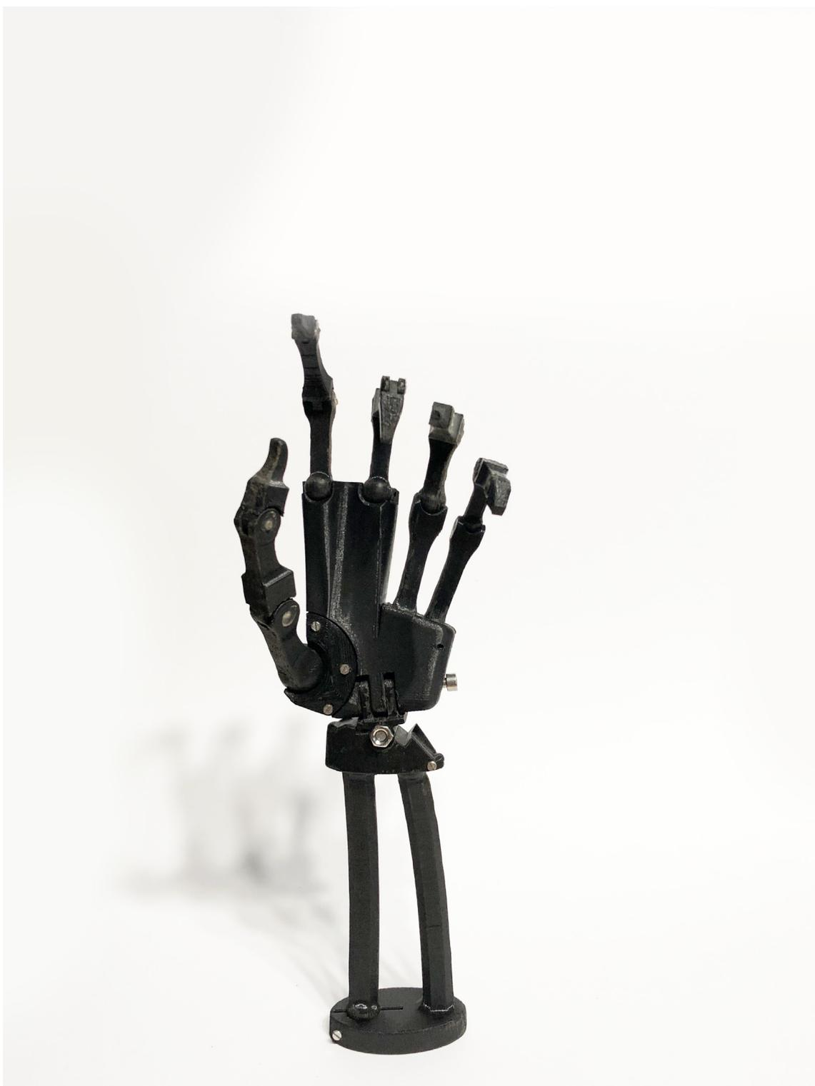
Fig. 139. Resultado do 1.º ensaio físico relativamente à sua articulação
