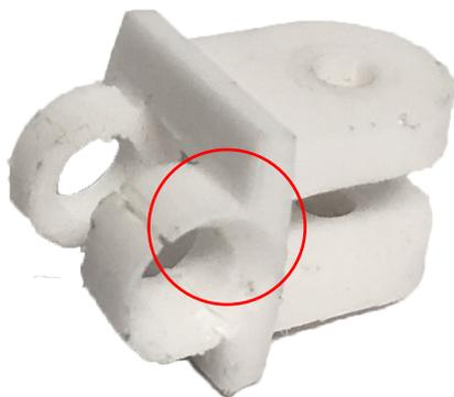
Fig. 94. Fratura na peça do pulso
