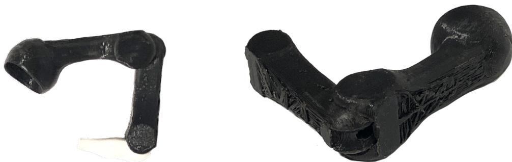
Fig. 134. teste de articulação das diversas peças, apresentando detalhe do encaixe desenvolvido
