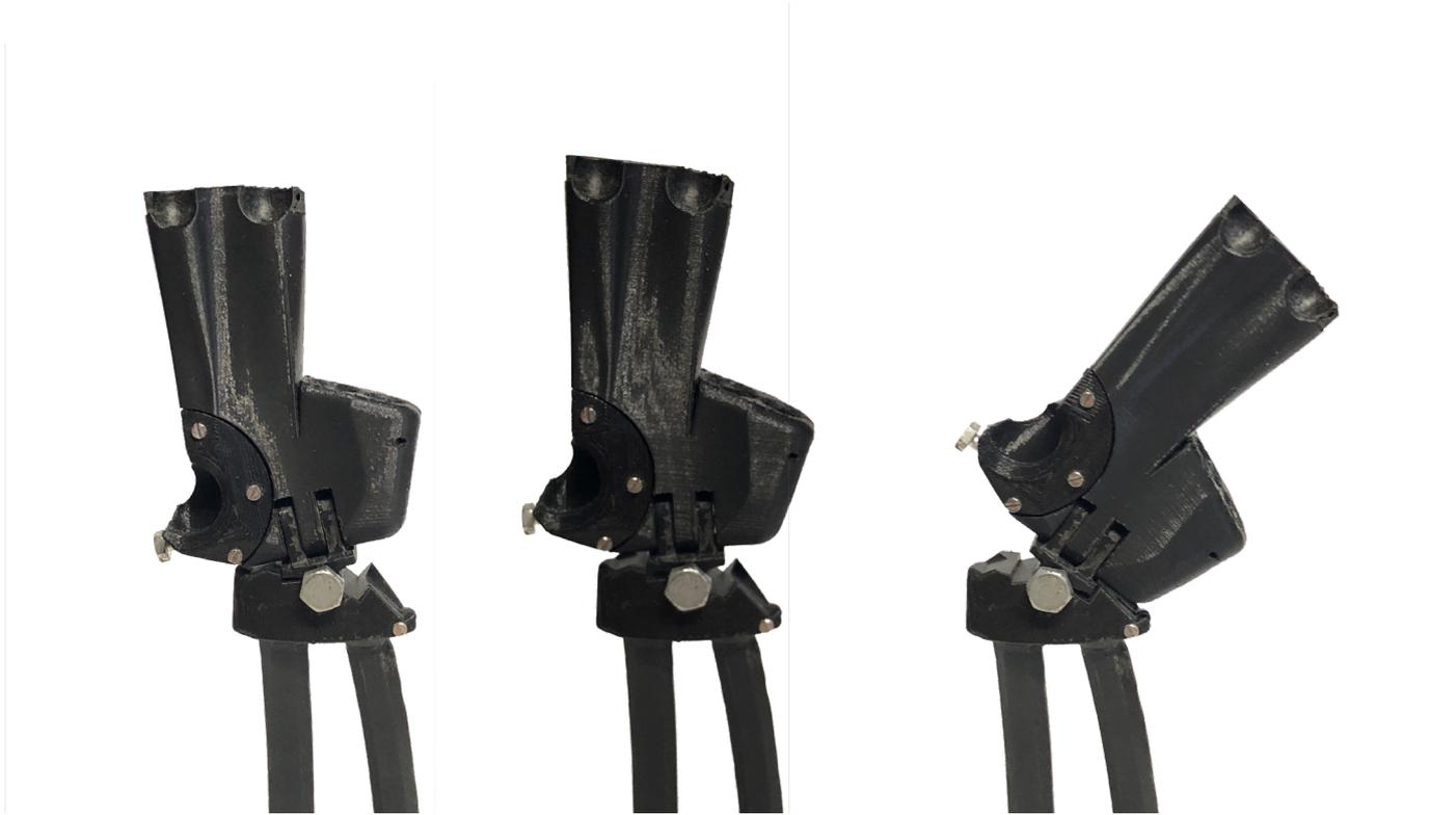
Fig. 85. demonstraç o dos graus de movimento no desvio ulnar e radial do pulso
