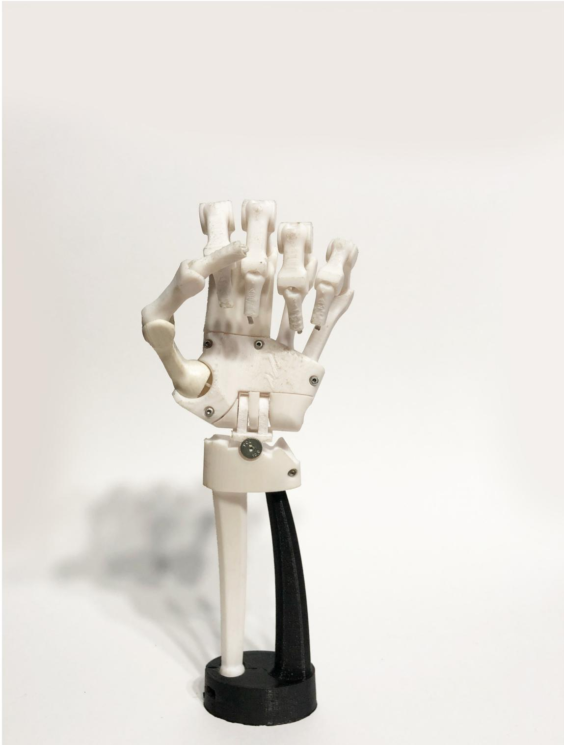
Fig. 143. Demonstração da Articulação da Estrutura Interna fechando a mão
