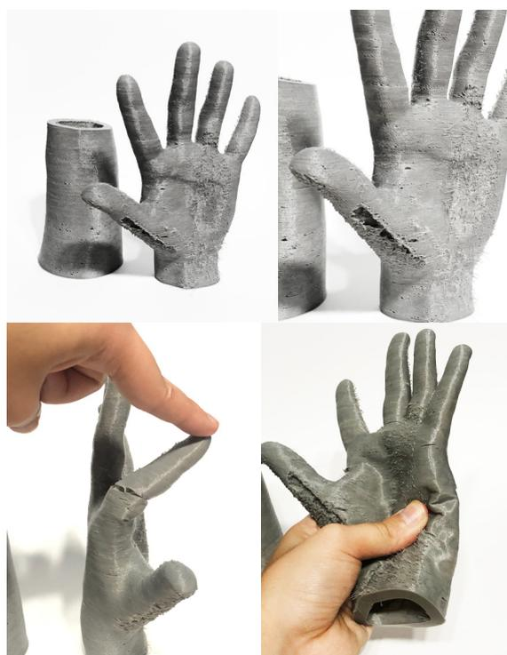
Fig. 173. foto da mão impressa em tpu com interior em gyroid e defeitos de impressão
