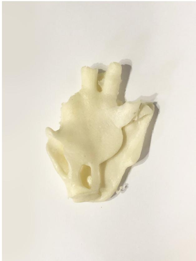
Fig. 158. resultado do primeiro teste com o poliuretano flexível
