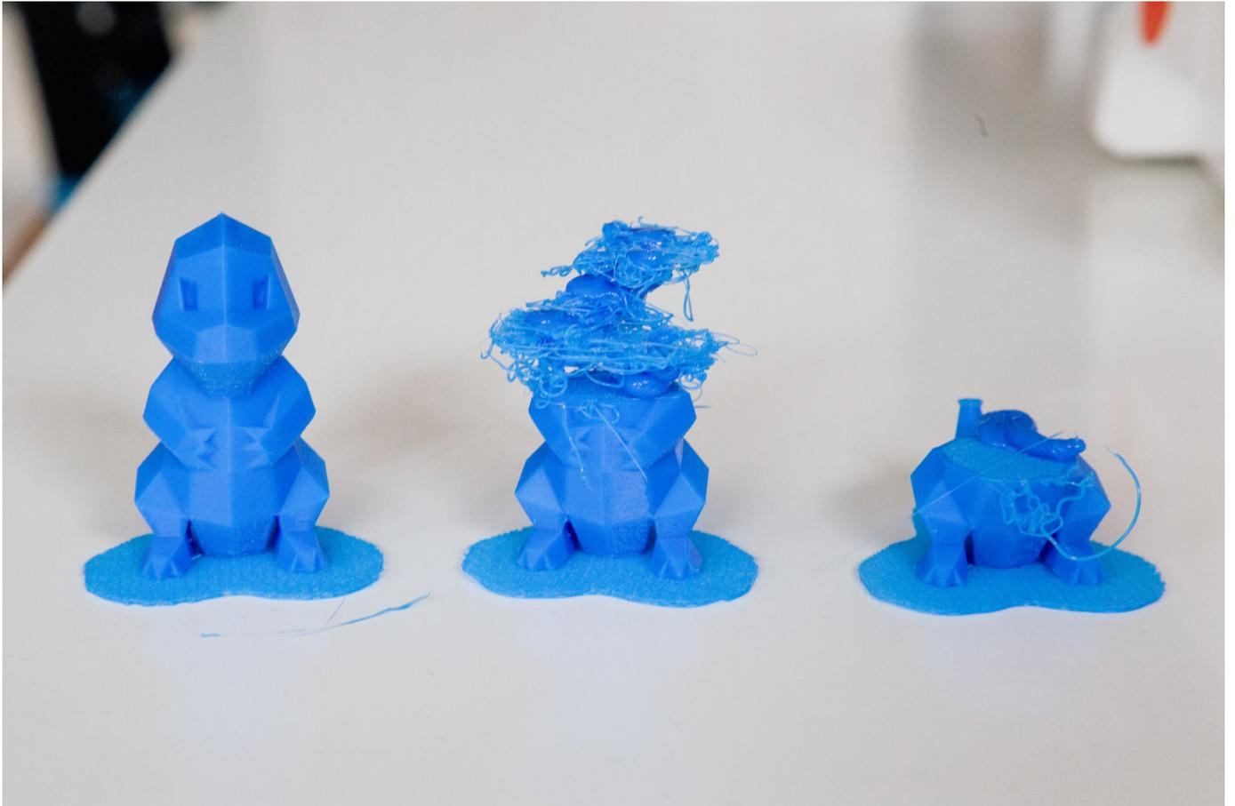
Fig. 47. Diferentes erros de impressão em FDM
