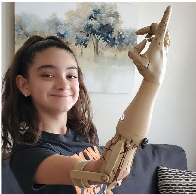
Fig. 28. Prótese transradial biônica
