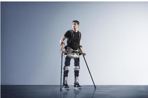
Fig. 58. Exoesqueleto phoenix que ajuda na movimentação e execução de cargos que requerem uma constante força, diminuindo danos físicos.
