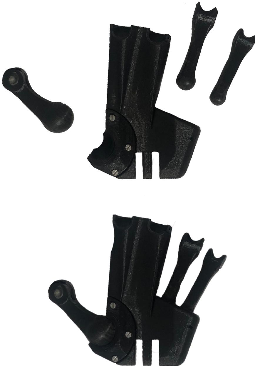
Fig. 103. Demonstração do 1º ensaio físico da palma e dos MC1, 4 e 5
