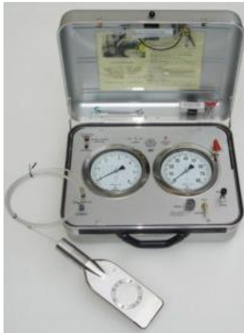
Figura 12- Unidade de medição no ensaio DMT
