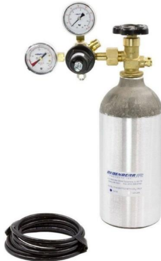
Figura 13- Garrafa de gás utilizada no ensaio DMT
