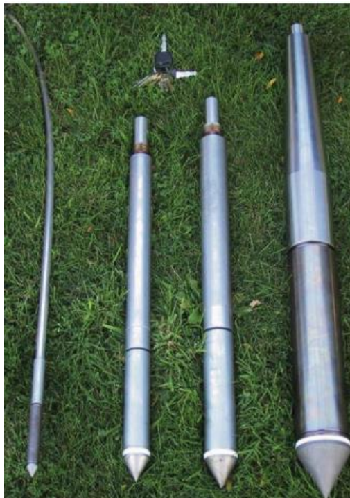
Figura 7- Diferentes tipos de pontas para o ensaio CPTU (Robertson & Cabal, 2010)
