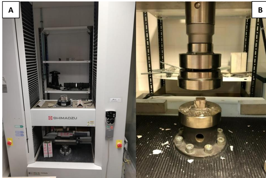
Figura 34- A) Máquina Universal de Ensaio Shimadzu AC-IC 100, B) Ensaio de resistência à compressão uniaxial de uma amostra.
