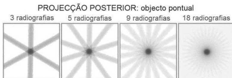
Figura 33- Reconstrução de um objeto pela aquisição de várias radiografias. Extraído de (Maurício et al., 2012).
